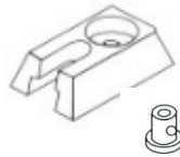
Spannschuh (in Verbindung mit Seilführung im Glasfalz)
